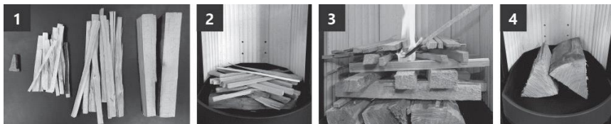
Fig. 4 Plaatsing van het hout in de kamer
