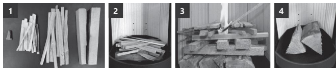
Fig. 4 Plaatsing van het hout in de kamer
