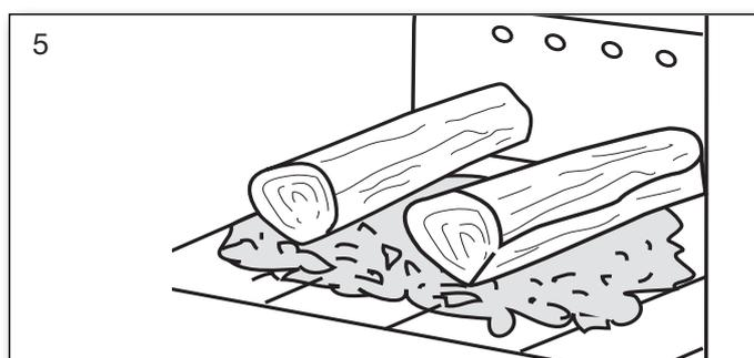
tué lorsqu'il y a encore une bonne couche de braises. Répartir les braises sur le fond, mais surtout à l'avant du poêle. Placer une couche de bûches sur les braises, perpendiculairement à la porte de chargement, 1,22 kg pour Icon-Line Eclipse série Voir la fig. 5.
