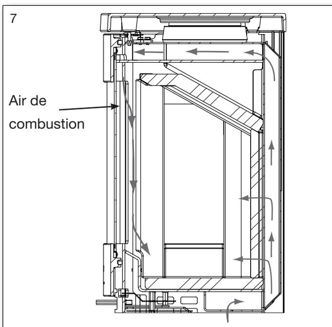
Le débit des gaz de combustion est le suivant : 4,5 grammes/seconde. Correspondant à 16,3m<sup>3</sup>/h air de combustion pour 1,22 kg bois.
