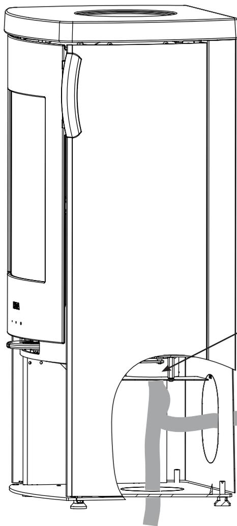
Clapet d'air  $\varnothing 100$
