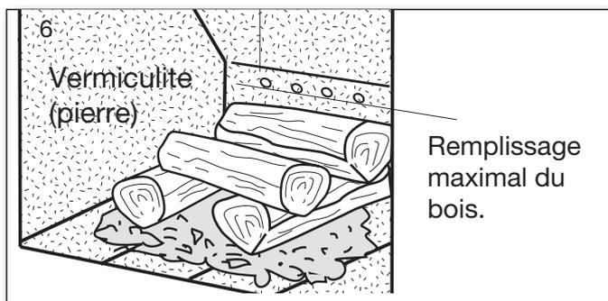
Le chargement du bois doit être maintenu en dessous de la rangée supérieure des orifices d'admission d'air et entre les orifices terminaux, de chaque côté. Voir la fig. 6.
